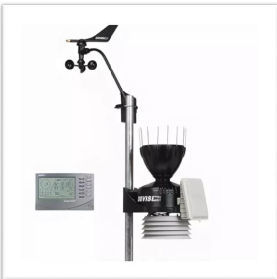
Рисунок 2. Метеостанция Davis Vantage Pro 2.
